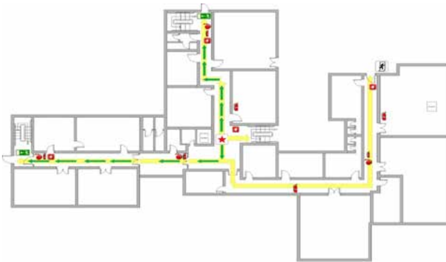
Şekil A.15.2: Tahliye Planında Kat Krokisi Örneği
