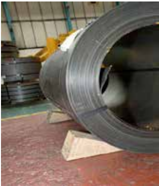
Şekil A.6.10: Silindirik malzemenin takozlarla sabitlenmesi
